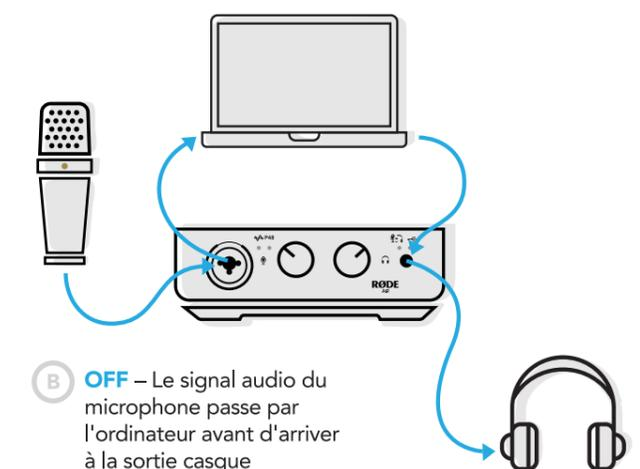
B OFF – Le signal audio du microphone passe par l'ordinateur avant d'arriver à la sortie casque
